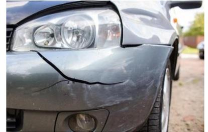
Para una buena y resistente reparación se necesita hacer una apertura a los dos lados de la ruptura de por lo menos un centímetro para cada lado, la forma de esta apertura debe ser en forma de "V" y profundizar lo más posible para que se aloje el material al lijar.
